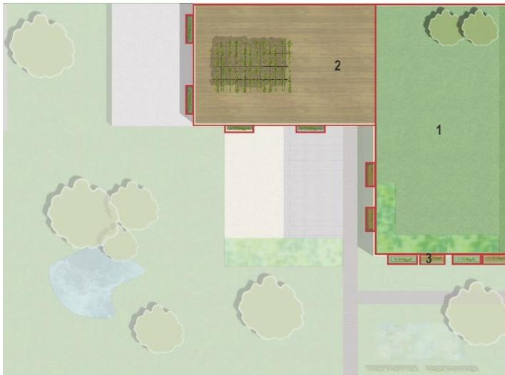
Abbildung 11: Überbaute Flächen differenziert nach Vegetationsflächen unterschiedlicher Schichtdicke (1) und unbegrünten Dachflächen (2); Fassadenbegrünung (3) (eigene Darstellung, 2024)
