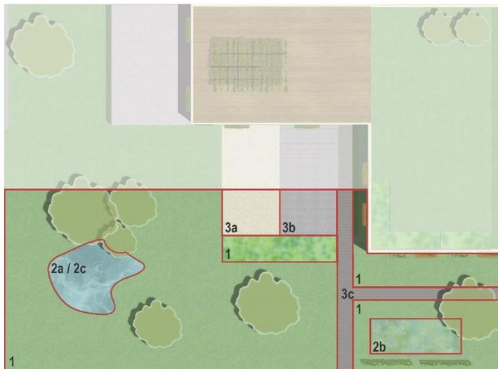
Hier wird jener Teil der Bauplatzfläche erfasst, der nicht als überbaute oder unterbaute Fläche eingeordnet ist, also über einen direkten Bodenanschluss verfügt (siehe ÖNORM EN 15221-6:2011; für die unterbauten bzw. überbauten Flächen siehe nächste Kapitel). Für die Anrechnung einer Fläche ist die Bepflanzung schlüssig nachzuweisen, d. h. im Gestaltungskonzept ist die zu bepflanzende Fläche entsprechend darzustellen (gilt auch für unterbaute bzw. überbaute Flächen).
