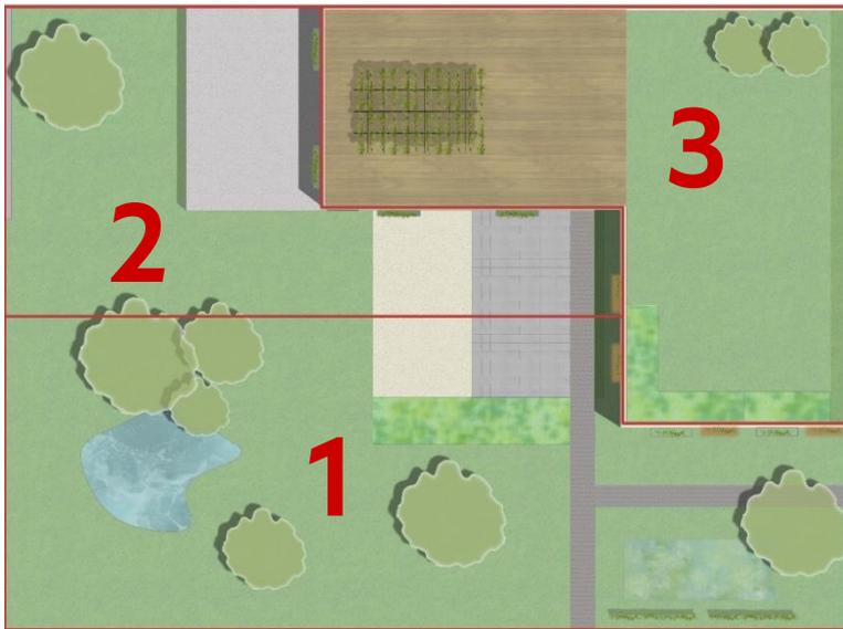
Abbildung 7: Differenzierung von unbebauten (1), unterbauten (2) und überbauten Flächen (3) auf einem Bauplatz (Beispiel, eigene Darstellung, 2024)
