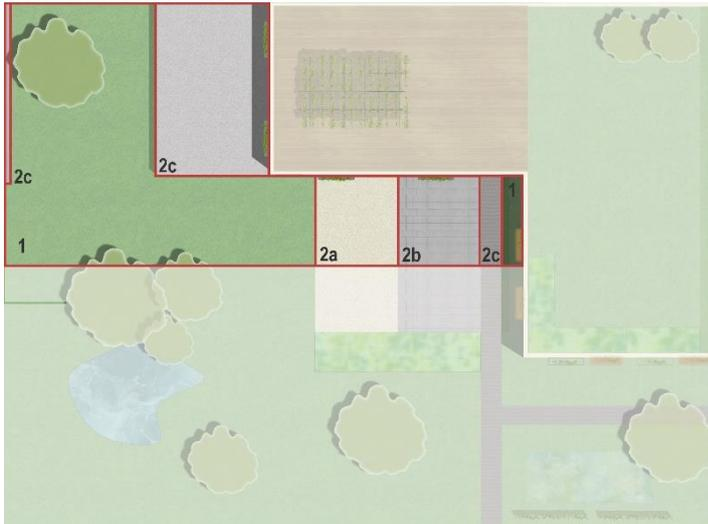
Hier wird jener Teil der Bauplatzfläche erfasst, der als unterbaute Fläche eingeordnet ist (Flächen der Teile eines Gebäudes, die sich bei Projektion auf eine horizontale Ebene unter Erdgleiche befinden, siehe ÖNORM EN 15221-6:2011), also Flächen des Bauplatzes über z. B. Tiefgaragen oder Kellern.
