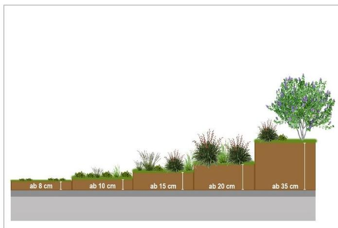
Abbildung 12: Aufbauhöhen und potenzielle Vegetation überbauter Flächen (eigene Darstellung, 2024)
