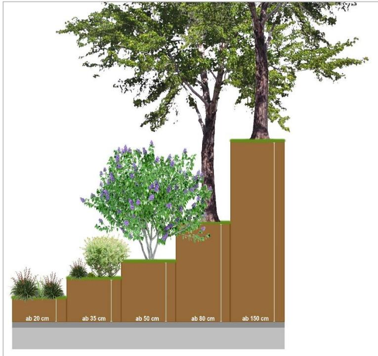
Abbildung 10: Aufbauhöhen und potenzielle Vegetation unterbauter Flächen (eigene Darstellung, 2024)
