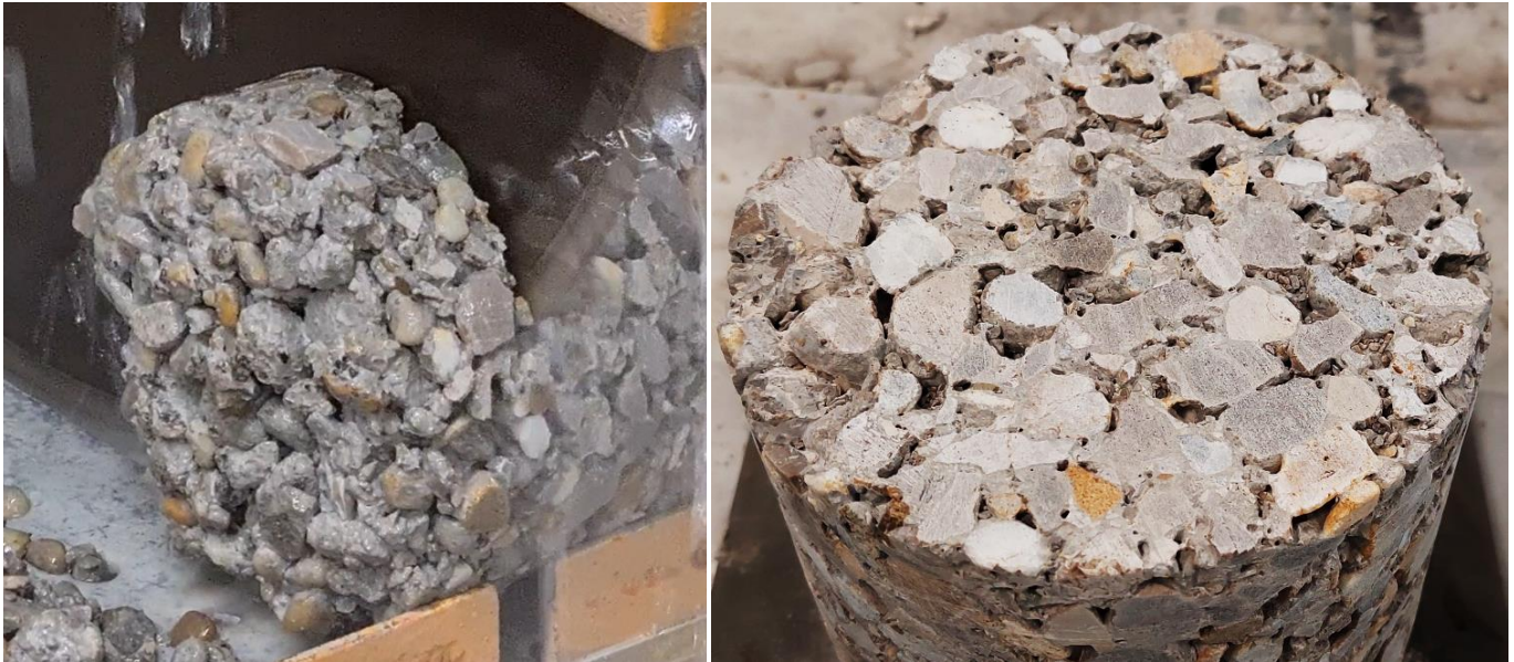
Abb. 9: PK während des Schneidvorganges (links) und Schnittfläche eines PK aus Versuchsfeld 10 (rechts: es sind kaum Kornausbrüche erfolgt).
