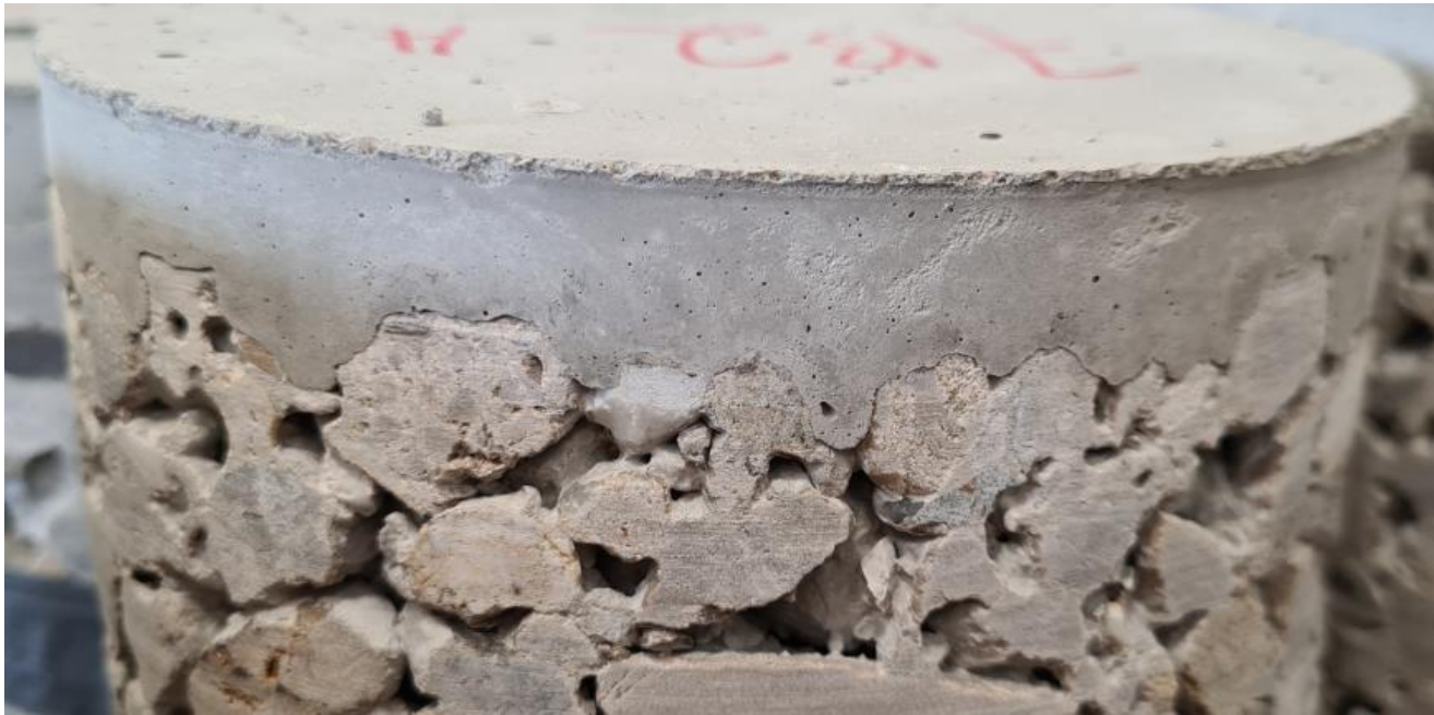
Abb. 7: Mit Zementmörtel abgegliche Prüffläche eines nicht geschnittenen PK (Serie M oder A).
