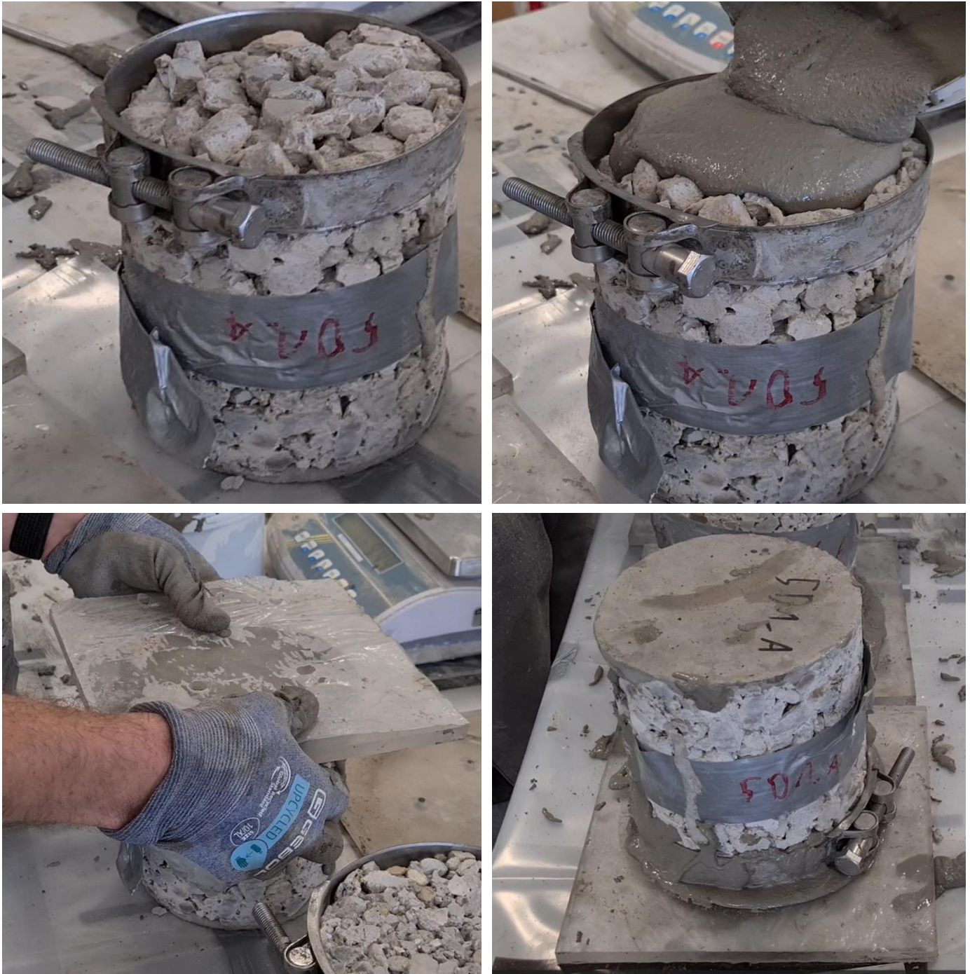
Abb. 6: Vorgang des Zementabgleiches einer künftigen Prüffläche eines PK des Versuchsfeldes 5: Anbringen der Stahlmanschette (links oben), Aufbringen des Zementmörtels (rechts oben), Glättung durch Aufdrücken der Plexiglasplatte (links unten), Stürzen des PK samt Plexiglasplatte und Erhärten des Zementmörtels (rechts unten).
