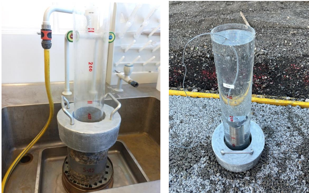
Abb. 4: Durchlässigkeitsmessung gemäß RVS 8.06.28 mit Bleimasse auf foliertem PK im Labor (links) und im Feld (rechts).
