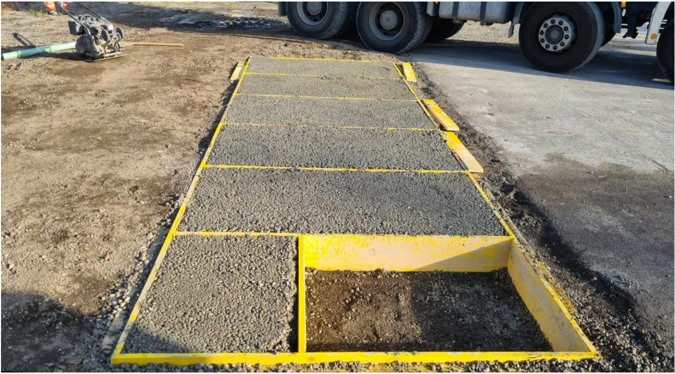
Abb. 1: 6 Probefelder vor erneutem Einbau der modifizierten Rezeptur in Feld P1.2. Links oben die verwendete Rüttelplatte.
