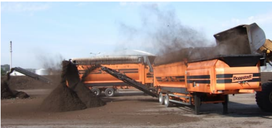
Abb. 30: Siebversuch, „Tandemaufstellung“ mit 2 Siebmaschinen (©MA 48)
