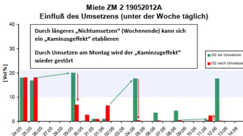
Abb. 39: Einfluss der Umsetzhäufigkeit auf den Sauerstoffgehalt in der Porenluft (Quelle: ABF BOKU)
